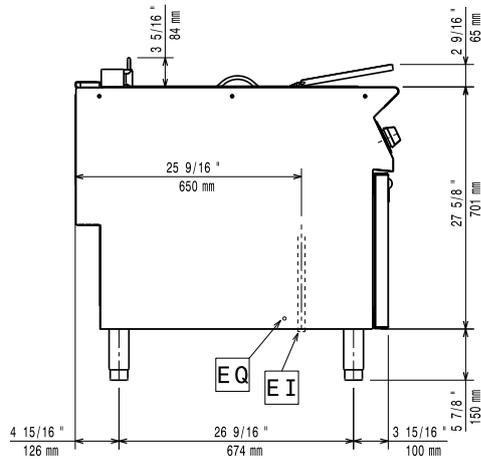
EI = Conexión eléctrica (energía)
